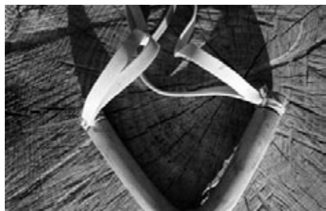
Ulteriore modalità di fissaggio di elastici di gomma, con cordino annodato.
