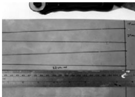
Ritaglio delle bande elastiche da una fascia Thera-Band.
