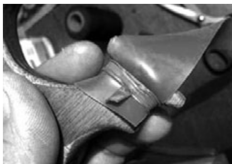
Fasi del fissaggio dell'elastico alla forcella.
