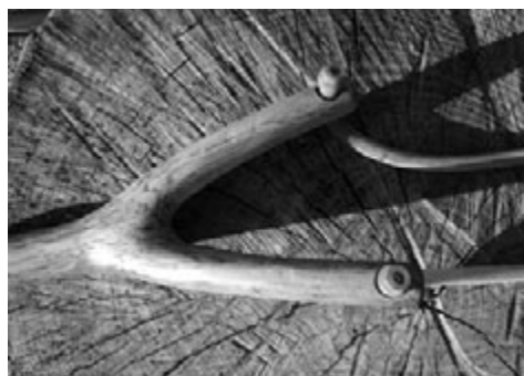
Elastico tubolare fissato alla forcella.
